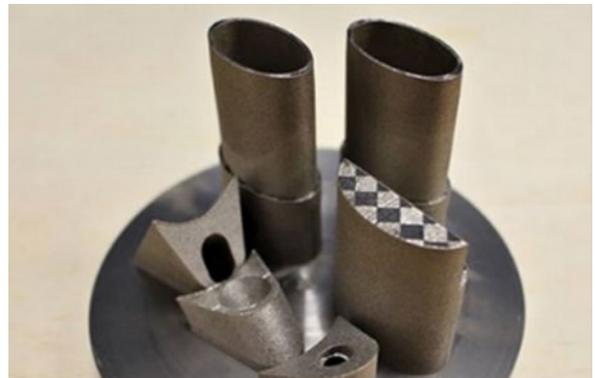
Abb. 2: Werkstücke hergestellt durch SLM
